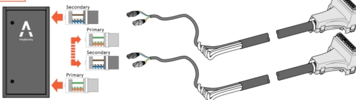
Billede 64: Forbindelse mellem SmartHub og to ConnectCable
