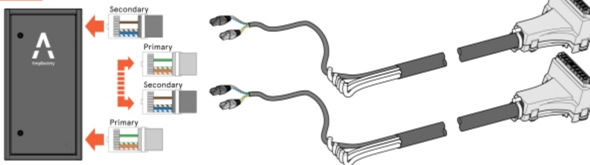
Illustration 60: Connexion entre le SmartHub et deux ConnectCables
