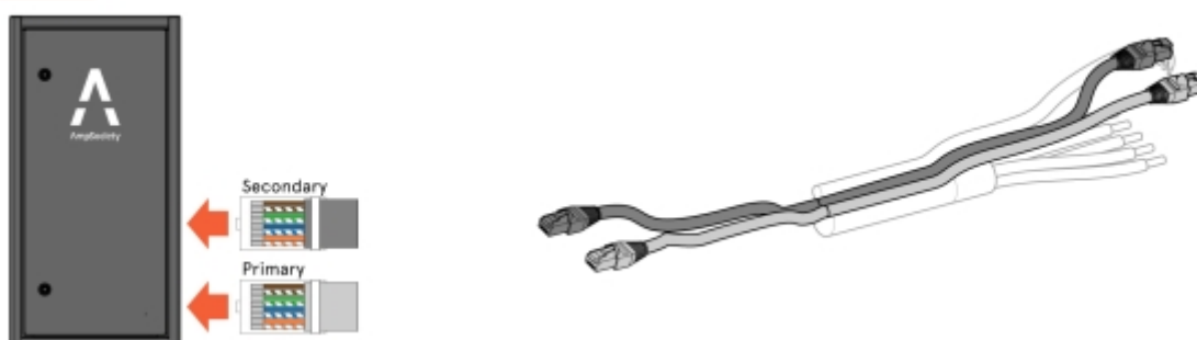
Illustration 61: Connexion entre le SmartHub et une WallConnection ou une GroundConnection
