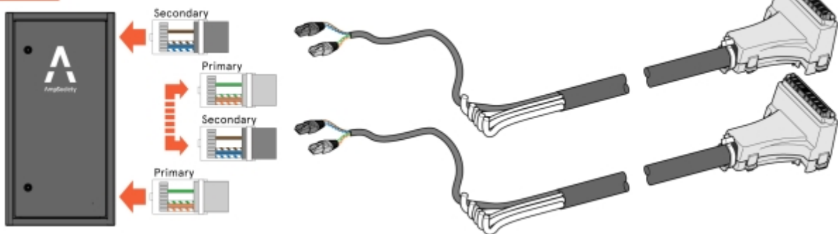
Illustration 64: Connexion entre le SmartHub et deux ConnectCables
