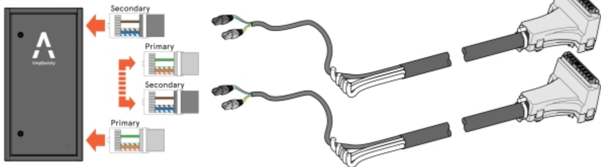
Illustration 60: Connexion entre le SmartHub et deux ConnectCables
