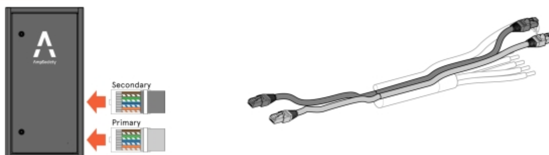
Bilde 61: Tilkobling mellom SmartHub og en WallConnection eller en GroundConnection
